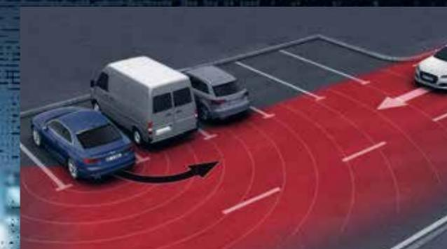
**Alerte de trafic transversal arrière<sup>1</sup>** – indique sur l'écran MMI lors des manœuvres en marche arrière pour s'extraire d'une place de stationnement en diagonale, les voitures en approche et peut contribuer, par le biais d'un avertissement sonore et un coup de frein, à éviter des situations jugées critiques
