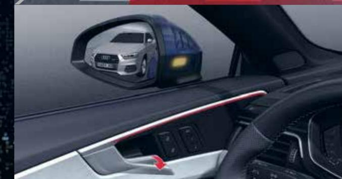
**Avertisseur de sortie<sup>1</sup>** – détecte les voitures et cyclistes en approche à l'arrière et prévient en cas de situation critique les passagers avant l'ouverture de la portière
