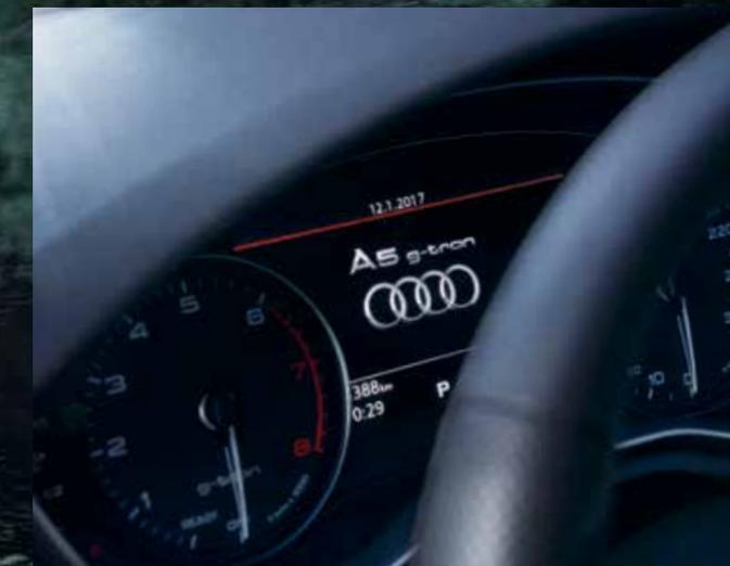
**Combiné d'instruments g-tron** – affichage clair du niveau du réservoir d'essence ainsi que de celui des réservoirs de GNC. Le système d'information du conducteur indique la consommation dans le mode de conduite actuel.
