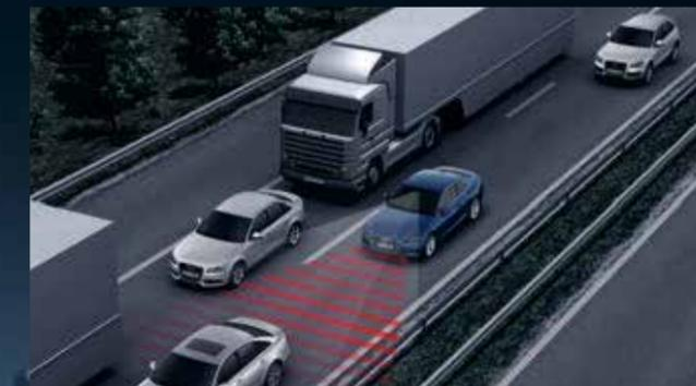
**Audi pre sense city<sup>1</sup>** – peut contribuer à éviter des collisions imminentes avec d'autres véhicules ou des piétons à des vitesses pouvant aller jusqu'à env. 85 km/h en émettant des signaux sonores et en freinant
