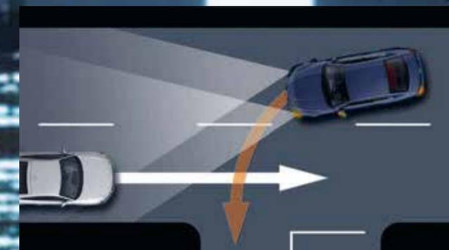
**Assistant de changement de direction à gauche<sup>1</sup>** – détecte les véhicules arrivant en sens inverse lors d'une bifurcation à gauche et freine dans les situations jugées critiques
