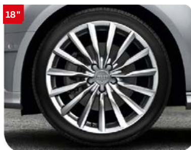
De série : Design luxe (version e-tron) Jantes en aluminium coulé style 15 branches en turbines Pneus : 225/40 R 18 En option : Design (version e-tron) Code : CV4
