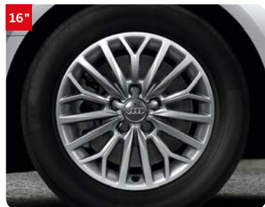
De série : A3, Business line Jantes en aluminium coulé style 15 branches en Y Pneus : 205/55 R 16 Code : C2F
