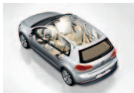
Les sept airbags de la Golf y compris le nouvel airbag de genoux conducteur.
