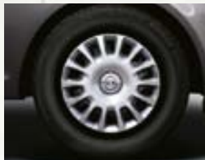
Jante acier avec enjoliveur, 5,5J x 14", 14 branches, pneus 185/70 R 14 (PA8). De série sur Essentia.
